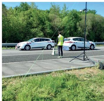
Evaluation sur piste d'essai de dispositifs de contrôle automatique des émissions sonores des véhicules (« radars bruit »)
