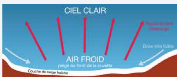
Figure 2 • Schéma de l'écoulement de vent catabatique. Source : Météo France
